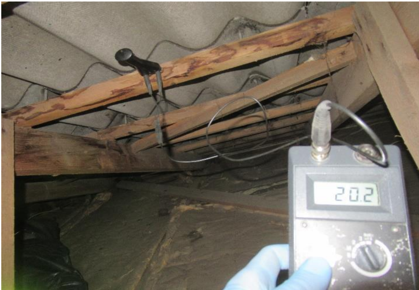
Eksempel på opfugtning af træværk – her lægter.
